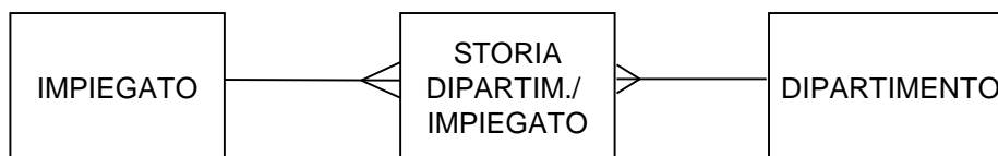
Figura 2.3.3 - Diagramma E/R precedente, risolto con due relazioni uno-a-molti unite da una ‘entità d’intersezione’
